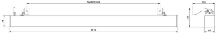
Рис.1 – Внешний вид прожектора (длина указана для SEVEN COLOR-XX-XX-1010)
