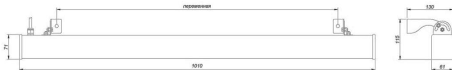
Рис.1 – Внешний вид прожектора (длина указана для SEVEN COLOR-XX-XX-XX-1010)
