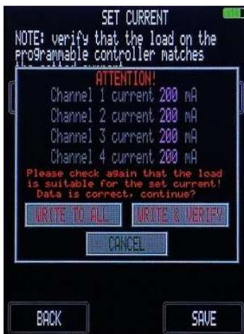
Рисунок 11. Предупреждение о записи значений токов в контроллер
