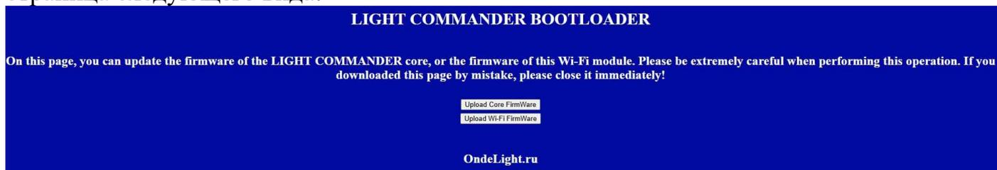
Для загрузки микропрограммы прибора используйте кнопку «**Upload Core Firmware**». Далее, произойдет перемещение на страницу, на которой необходимо указать адрес файла \*.OLB и нажать кнопку «Upload»
