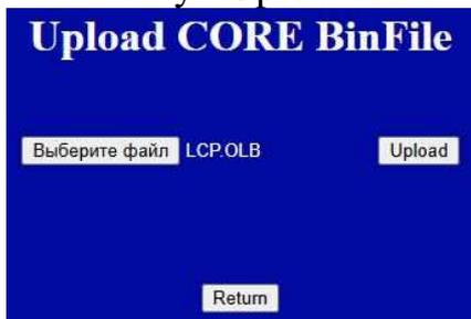
После успешной загрузки файла будет выведена страница с указанием корректного размера файла, а на дисплее прибора будет предложено проверить/удалить файл либо выключить питание. Нажмите кнопку «**CHECK**» для проверки целостности файла микропрограммы.
