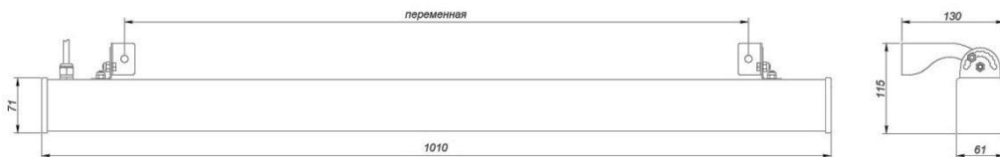
Рис.1 – Внешний вид прожектора (длина указана для SEVEN-48-XX-XX-XX-1020)
