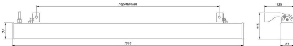
Рис.1 – Внешний вид прожектора (длина указана для SEVEN-48-XX-XX-XX-1020)
