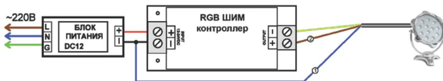
Рис.2 – Схема подключения одноцветного проектора
