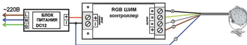
Рис.3 – Схема подключения RGB проектора
