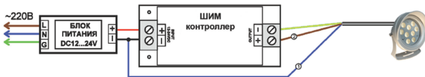
Рис.2 – Схема подключения одноцветного прожектора (1 – синий, 2 – коричневый, б/н – желтый с зеленой полосой)
