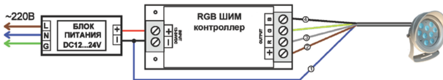
Рис.3 – Схема подключения RGB прожектора (1 – синий, 2 – коричневый, 3 – серый, 4 – черный, б/н – желтый с зеленой полосой)
